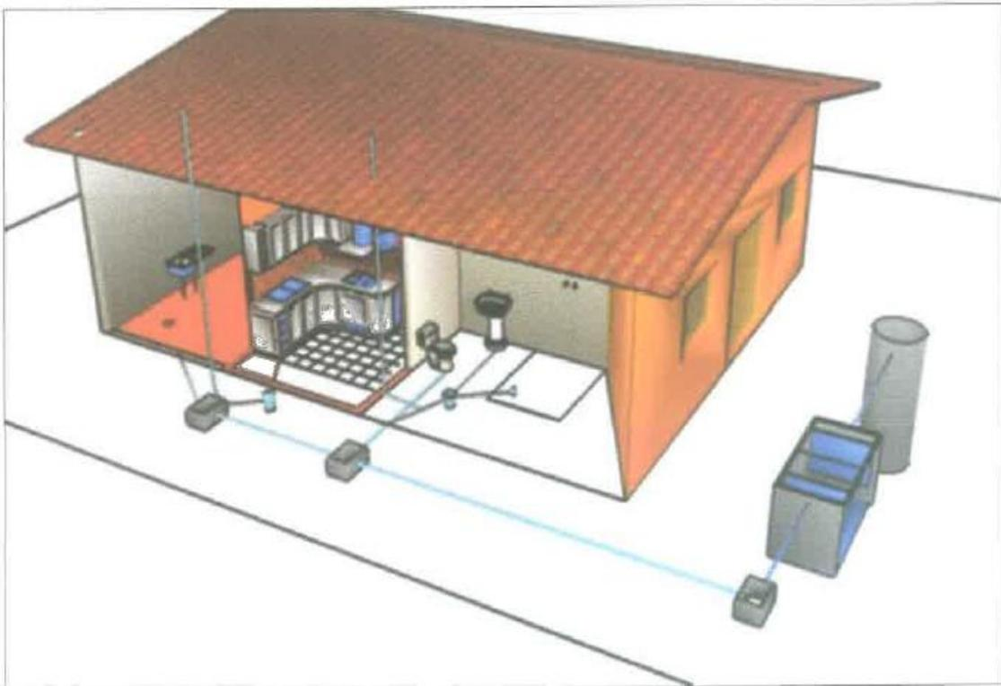
Capacidade para até 06 (seis) pessoas por Unidade Sanitária Individual (USI), com volume mínimo nominal de 1.990 Litros para fossa séptica, conforme a NBR 7229/93. Para o filtro anaeróbio de fluxo ascendente, um volume mínimo do leito filtrante de 1.000 Litros, de acordo com a NBR 13969/97.
